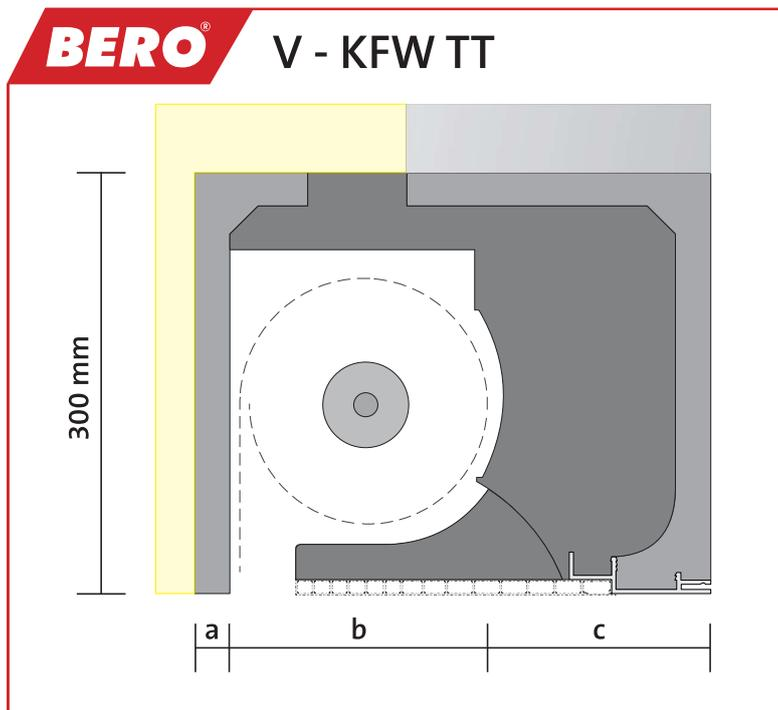
Selbsttragender Rollladenkasten aus bewehrtem BEROPor-Leichtbeton für ein Mauerwerk mit Wärmedämm-Verbundsystem und einer **inneren Montageöffnung**. Optimierte Innendämmung und thermische Trennung aus BERO® Porozell (WLS031), Kunststoffabschlussprofil innen inklusive Putzeinsteckschiene, thermisch getrennte Kopfteile mit Stehbolzen zur Aufnahme der Lagerhalter.
